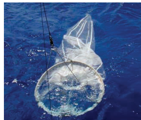
図2. 動物プランクトンを採集するプランクトンネット。モニタリング観測では、水深150mから鉛直採集を行っています。
