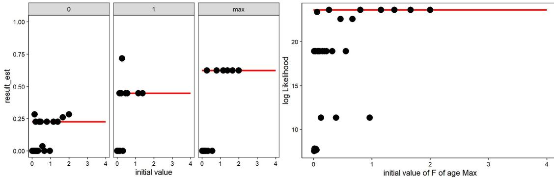
図 2. frasyr でジッター解析 (do\_estcheck\_vpa) を実行した時の作図. 左図は初期値 (横軸) を変えてパラメータ推定した場合のパラメータ推定値 (縦軸) を表す. 赤線はデフォルトの初期値を用いた場合のパラメータ推定値. ここでは 0 に近い初期値を用いると推定値は極端に小さな値をとる傾向がみられる. 右図は最終年最高齢の F の初期値 (横軸) と対数尤度 (縦軸) を示し, 左図右側の “max” の横軸と対応する. この結果から, 0.5~2 までの間の初期値を取れば, 多くの場合で最尤推定値を得られていることが確認でき, 考えうる初期値の範囲でデフォルトの初期値から推定された対数尤度 (右図赤線) よりも大きい結果がないことから, デフォルトの初期値の結果が大域解であることが確認できる.
