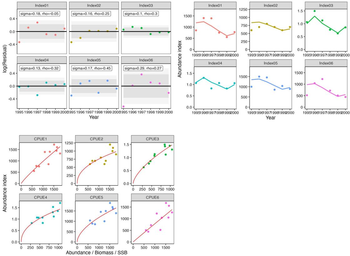
図 3. frasyr で残差解析 (plot\_residual\_vpa) を実行した時の作図結果. 残差の時系列プロット (左上図), 資源量指数の予測値と観測値の時系列プロット (右上図) と資源量指数に対する推定資源量指数のプロットの図 (左下図). 左上図において,  $\sigma$  は観測誤差,  $\rho$  は残差の自己相関係数, 薄い灰色は  $1.96\sigma$  区間, 濃い灰色は  $1.28\sigma$  区間を表す.
