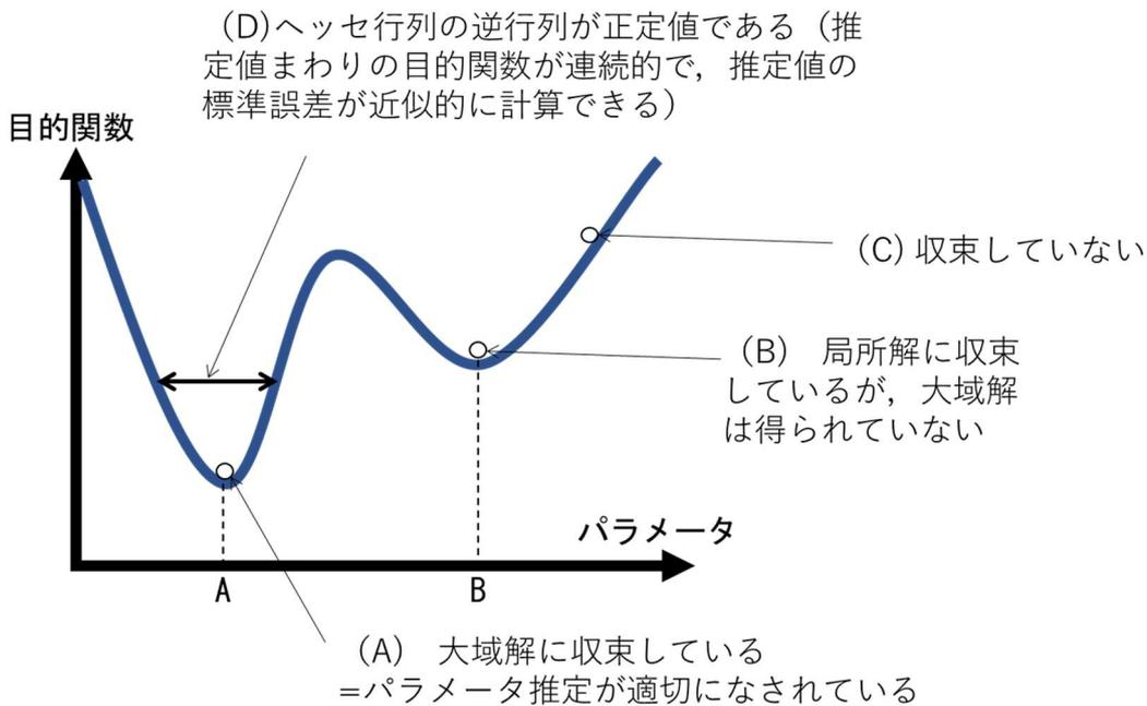
図1. 最適化を用いたパラメータ推定概念. ここで縦軸の目的関数は、最小二乗法の場合には残差平方和、最尤法の場合には負の尤度となり、目的関数が最も小さくなる時のパラメータの値（図のA）がいわゆる「推定値」となる. 適切な推定値が得られている場合というのは、解が収束していること（目的関数の微分がゼロになるような値に解が推定されているか）だけでなく、現実的なパラメータの範囲内で最も目的関数の値が小さくなるようなところの解が得られている（大域解が得られている）必要がある. 例えば、図のBは、解が収束はしているが局所解に陥ってしまっており、大域解が得られていない. また、図のCの状態は、解が収束もしていない. さらに、実用上は、大域解を得た上で、ヘッセ行列の逆行列が正定値であること（図のD）も適切なパラメータ推定の条件として求められる.
