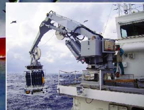
採水装置付きCTD (塩分・水温・水深計測装置)
